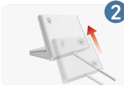
步骤2: 将读写器从下向上滑入支架, 并将连接线放置在底座下方的插槽内
